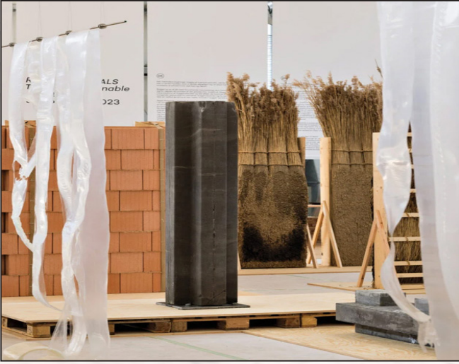
படம் 2: பயோசிமெண்ட் டிஸ்டிலேஷன் செய்து செய்யப்பட்ட ஒரு பயோகாங்க்ரிட் தரண் (கோர்பென்ஹைக்ஸ் 2023)
